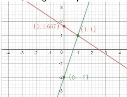
El punto de corte de ambas rectas corresponde con la solución del sistema de ecuaciones. En este caso, se ve claramente que el punto de corte es  $(1, 1)$ , por lo que la solución del sistema es  $x=1$ ,  $y=1$ , que son las coordenadas del punto de corte.
