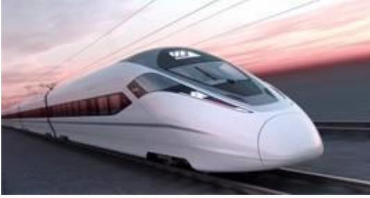
Ilustración 3: el tren bala, su diseño aerodinámico es inspiración del Martín Pescador
